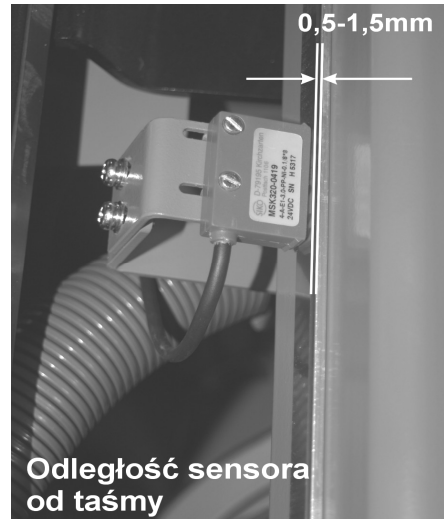
Dopuszczalne odchyłki przy montowaniu sensora MSK 320
